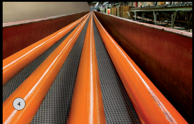
Cama de 200m de longitud para pruebas de presión
